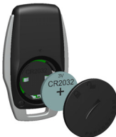
Figure 1 Remplacement de la batterie
